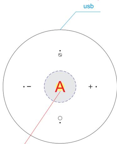
световой индикатор - загорается при включении устройства
